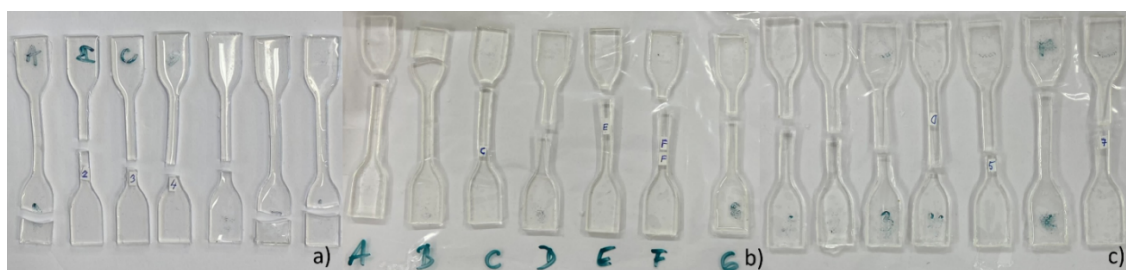
Obrázek 48: Fotografie polymeru SYLGARD 184 natrhané vzorky tělísek, a) Sylgard ref 0 kGy, b) Sylgard OZ1 27,8 kGy, c) Sylgard OZ2 260,4 kGy.
