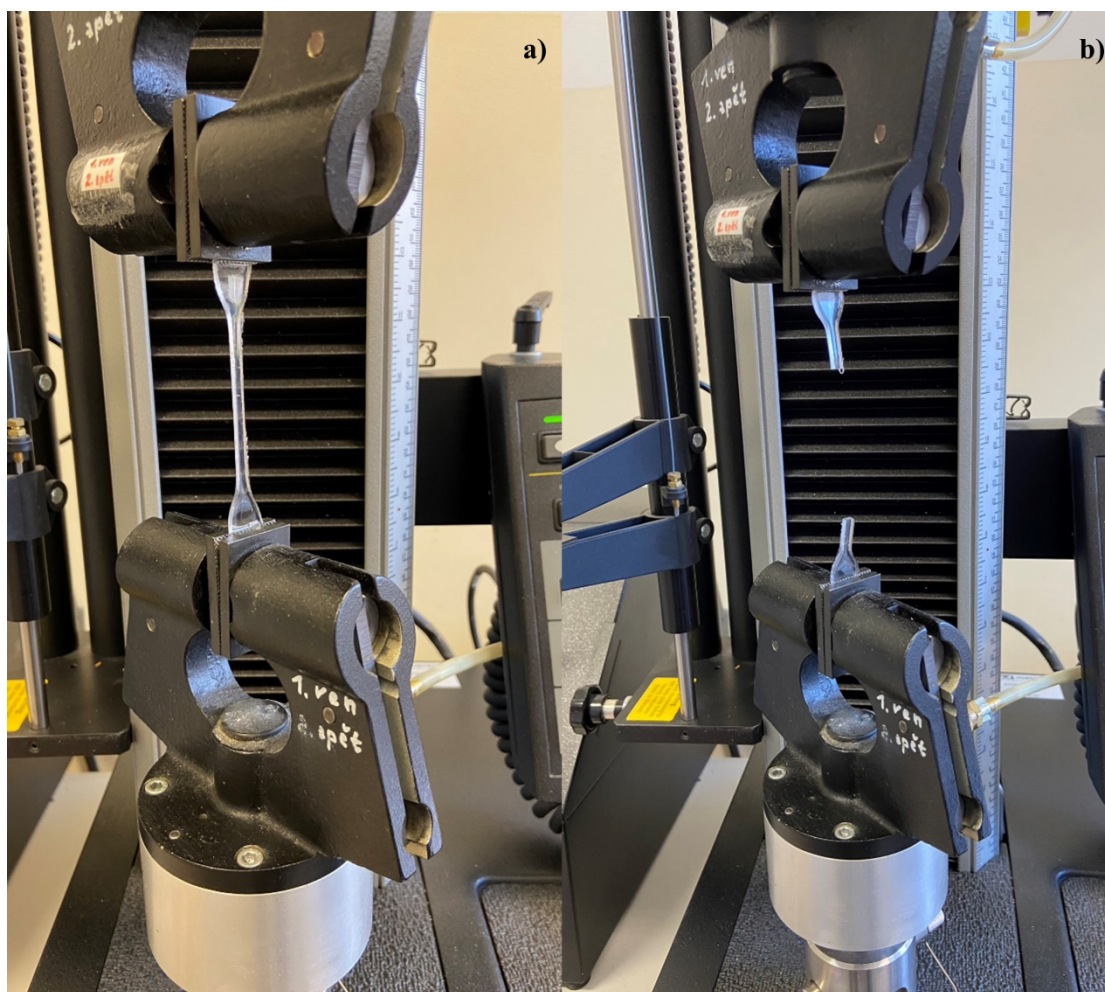
Obrázek 4: Fotografie extenzometru s vysokým zdvihem Instron XL 2603-084 v akreditované zkušební laboratoři na pracovišti Radiační chemie a kvalifikace na prostředí, ÚJV Řež, a.s., a) fotografie vzorku před přetrhnutím, b) fotografie vzorku po přetrhnutí.
