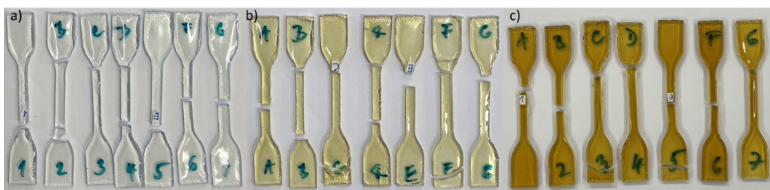
Obrázek 37: Fotografie vzorků zkušebních těles 3DM TOUGH CLEAR po zkoušce roztažnosti (trhání) a) 3DM ref 0 kGy, b) 3DM OZ1 27,8 kGy, c) 3DM OZ2 260,4 kGy.
